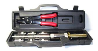
**Назначение**: инструмент применяется при замене сальников направляющих втулок клапанов газораспределительного механизма двигателя внутреннего сгорания. (маслосъемных колпачков)
